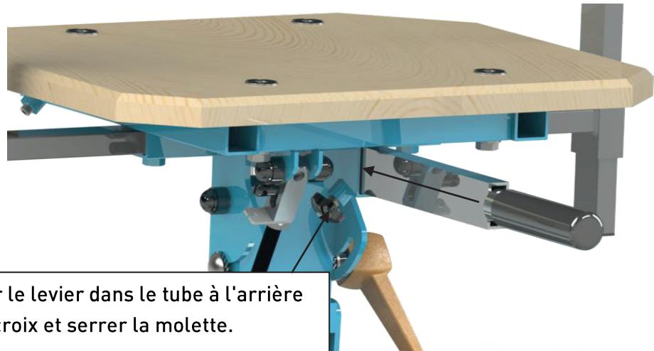
Placer le levier dans le tube à l'arrière de la croix et serrer la molette.
