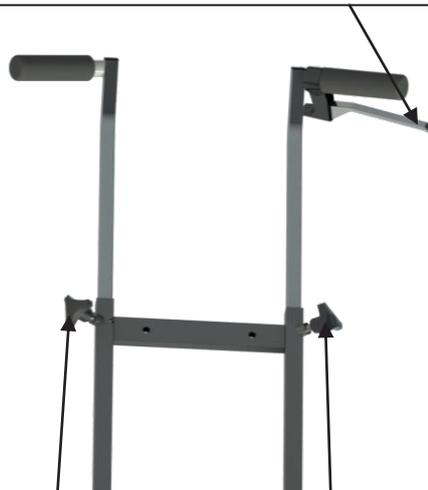
Régler la hauteur du guidon et serrer les molettes.
