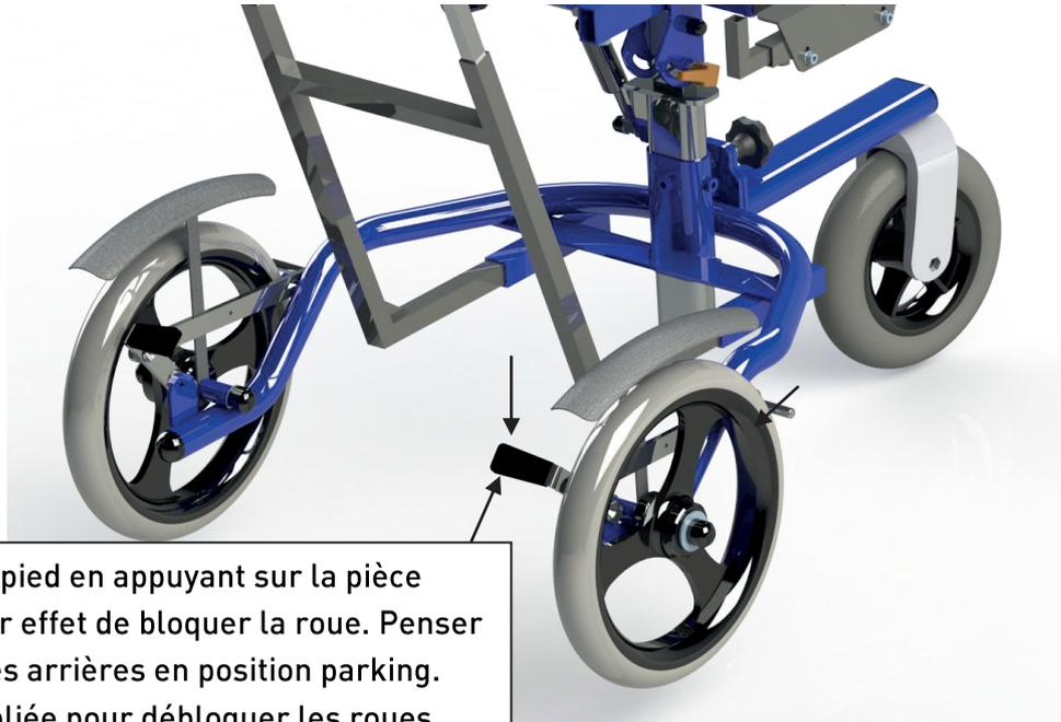
Actionner le frein à pied en appuyant sur la pièce pliée; cela aura pour effet de bloquer la roue. Penser à bloquer les 2 roues arrière en position parking. Remonter la pièce pliée pour débloquer les roues.
