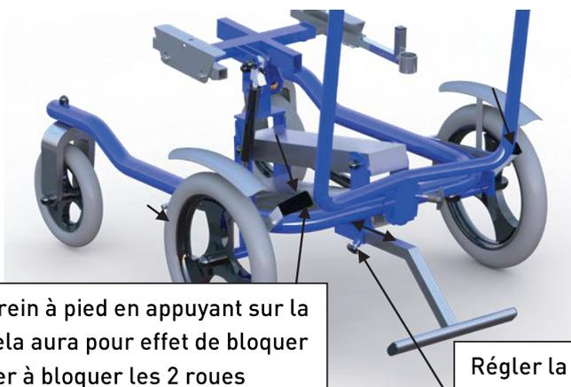
Actionner le frein à pied en appuyant sur la pièce pliée; cela aura pour effet de bloquer la roue. Penser à bloquer les 2 roues arrières en position parking. Remonter la pièce pliée pour débloquer les roues.
